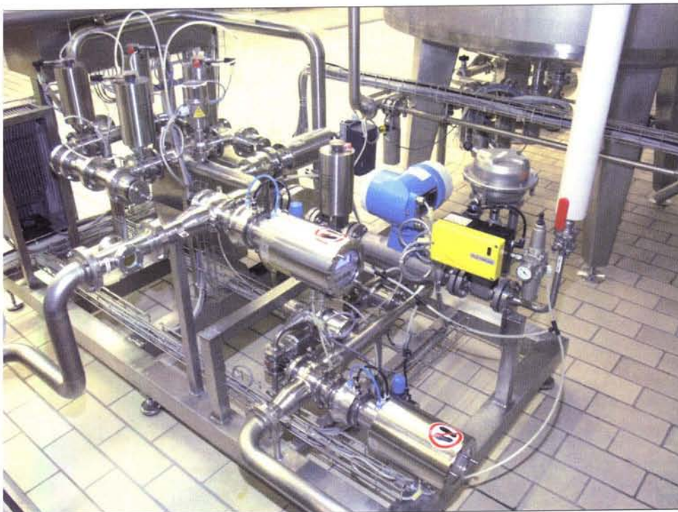
Im Vordergrund: die beiden Online-CO 2 -Meßgeräte (Einlauf und Auslauf), dahinter der Cavitator zur Karbonisierung. (Fotos: CavSys)
