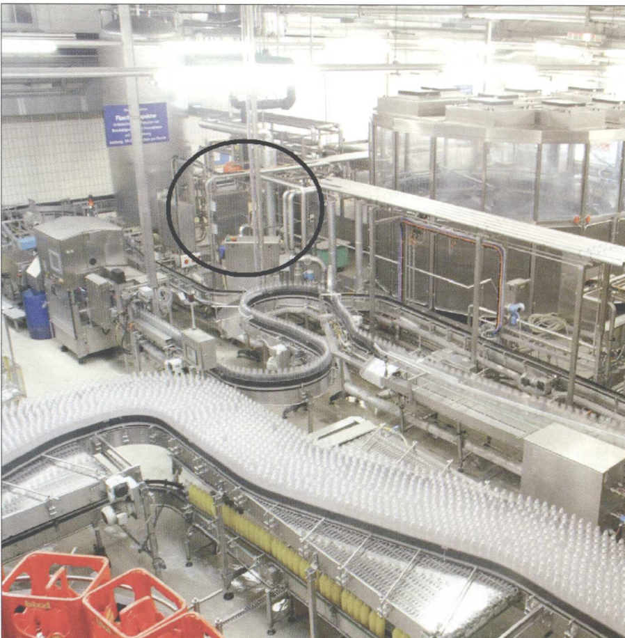
Die Mischanlage (im markierten Kreis) wurde als Plug-and-Play-Ausführung geliefert, geregelt werden sie über die Steuerung des Füllers.
