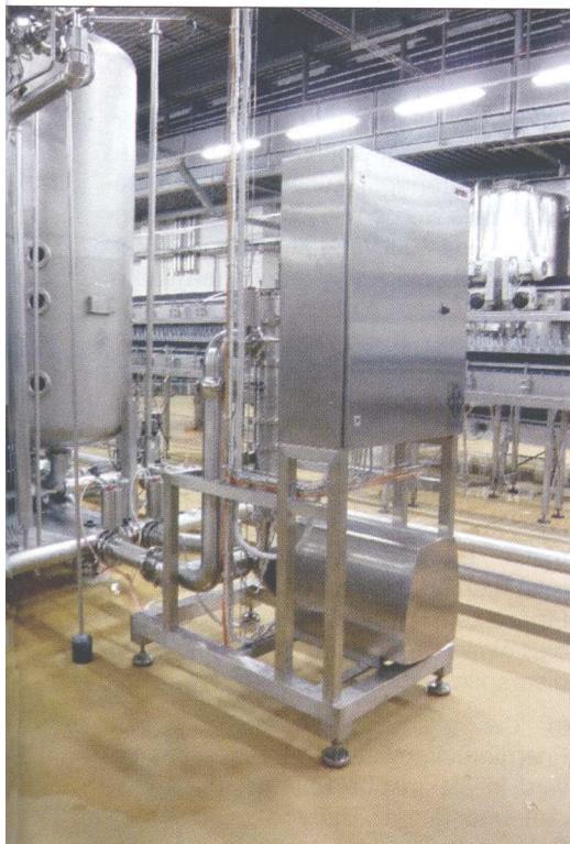
Bis zu 33000 Liter/h ungekühltes Getränk kann über das Gerät beruhigt werden.
