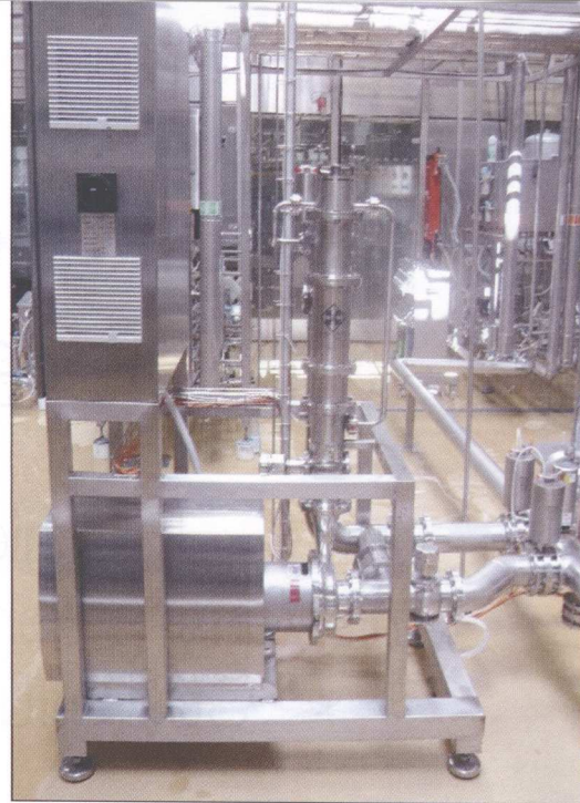
Kavitative Mischtechnologie für alle pumpfähigen Medien zur Herstellung homogener Mischungen.
